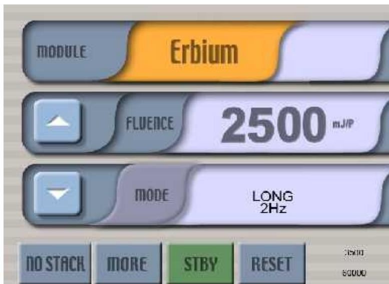
A energia total  $E$  (mJ/Pixel) é igual a potência aplicada  $P$  (Power) multiplicada pelo  $T$  (duração do pulso) –  $E=P \times T$ .
